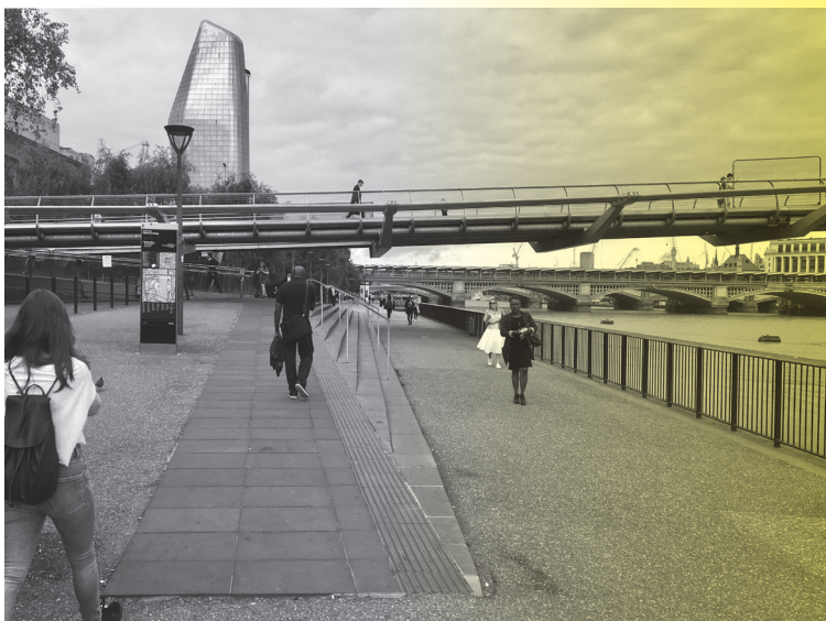
Percorso urbano inclusivo, Londra, Lungo Fiume area Millennium Bridge, l'incrocio tra gradini e rampa è trattato ed è inserito in un percorso ampio che permette alle carrozzine di evitare i tratti più rischiosi
