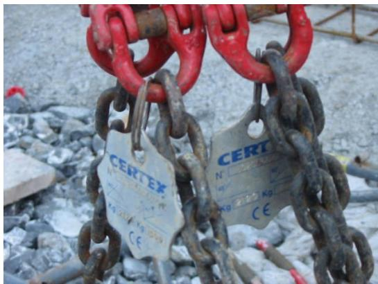
Ne deriva che anche l'autocostruzione di accessori di sollevamento (ad es. bilancini) è soggetta alle procedure di valutazione della conformità previste dalla Direttiva 2006/42/CE. Gli accessori autocostruiti devono essere marcati CE prima del loro utilizzo, corredati di istruzioni e dichiarazione CE di conformità.
